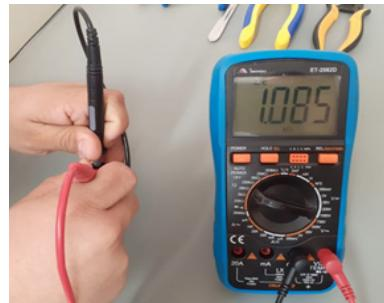
**Lembrete:** Cada veículo possui um sensor ABS com valor específico de resistência, que varia de acordo com a bitola e com o número de voltas (espiras) da bobina.
